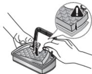
6. Remettez le groupe filtrant réassemblé dans le corps de l'aspirateur.
