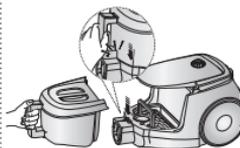
6. Avant réutilisation, poussez le réservoir de poussière à l'intérieur du corps de l'aspirateur jusqu'à entendre un « clic ».
