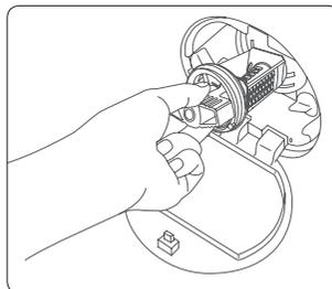
6. Nettoyez le filtre à impuretés à l'aide des brosses souples. Assurez-vous que l'hélice de la pompe de vidange située derrière le filtre n'est pas bloquée.
