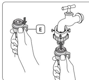
7. Raccordez l'autre extrémité du tuyau d'arrivée d'eau dans la vanne d'alimentation en eau située à l'arrière du lave-linge. Tournez le tuyau dans le sens horaire pour le serrer.
