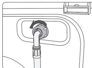
4. Utilisez une pince pour retirer le filtre à maille au niveau de l'orifice de la vanne d'alimentation en eau.
