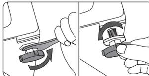
3. Une fois la mise à niveau effectuée, serrez les écrous à l'aide de la clé.
