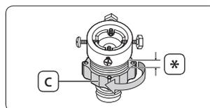
4. Insérez l'adaptateur dans le robinet, et serrez les vis tout en soulevant l'adaptateur.
