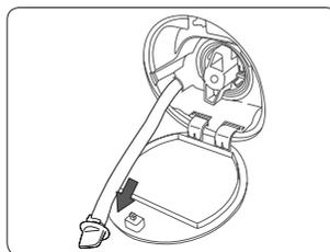
4. Tout en tenant l'extrémité du tuyau de vidange, ouvrez le bouchon du tuyau.
