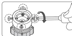
3. Maintenez l'adaptateur et tournez la partie (C) dans le sens de la flèche pour le desserrer de 5 mm (\*).
