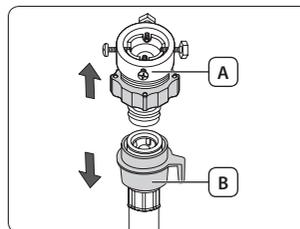
2. Utilisez un tournevis cruciforme pour serrer les quatre vis sur l'adaptateur.
